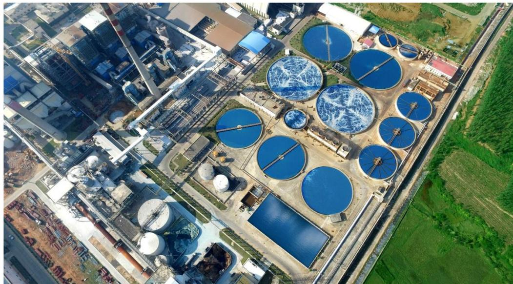
晨鸣秉承绿色发展、环保先行的理念，全面推行清洁生产和资源的综合利用。公司先后投资40多亿元用于环保工程，在行业内率先投用中水回用工程，回用率达到40%以上，吨纸耗水量降至3.5吨以下，处于行业领先水平。
